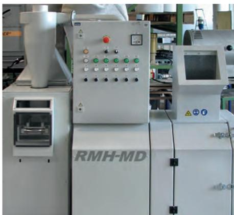
Kabelgranulieranlage: Recycling von Kupfer aus Kabelschrott.
