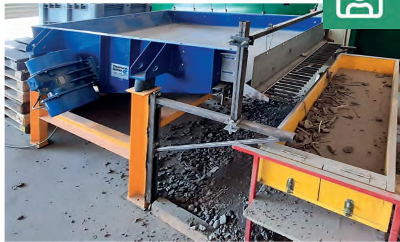
Langteilseparator: Separation von Besteck und anderen Edelstahlteilen aus Kehrlichtverbrennungssasche.
