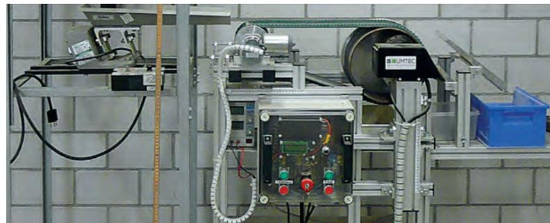
Wirbelstromscheider: Recycling von Nichteisenmetallen aus mineralischen Abfällen.
